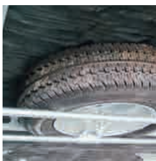
Reservhjulshållare AL-KO 1. Enkel (X0289) 2. Boggi (X0063)
