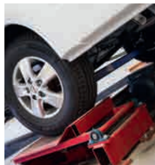
Hållbarhetstest simuleras i en skakbänk motsvarande 10 000 mil normal körning.
