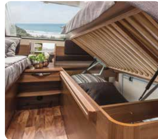
Gasdruckfedern für leichten und bequemen Zugang.
