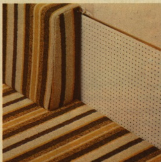
Rückwandbelüftung, bei allen Lords ab 600 serienmäßig. Wichtig fürs Wintercaravaning!
