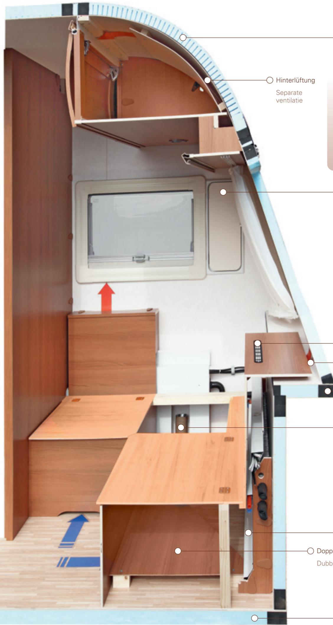
○ Eine 45 mm starke Styrofoam-Sandwich-Seitenwand mit PU-Einlage sorgt selbst bei tiefen Minustemperaturen für eine kuschelige Wärme
