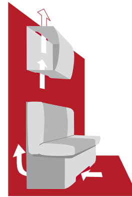
TOP-Belüftungskonzept durch hinterlüftete Möbel und doppelte Böden
