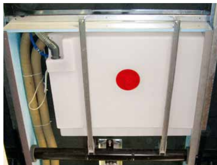
Multifunktionsdoppelboden (Serie, außer Breezer A-Modelle)
