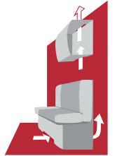
TOP-Belüftungskonzept durch hinterlüftete Möbel und doppelte Böden
