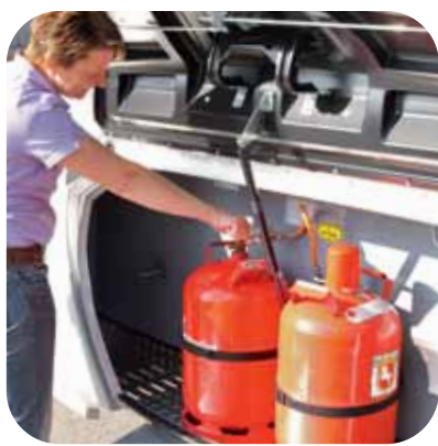
Flaschenkasten mit Aluminiumboden Gasflessenkast met aluminiumbodem
