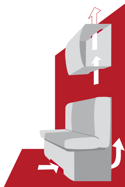
Serienmäßig doppelte Böden für optimale Luftzirkulation
