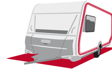
TOP-Dämmungswerte durch Styrofoam-Isolierung (serienmäßig im Scandica, optional im Musica und Maestro)
