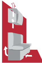
TOP-Belüftungskonzept durch hinterlüftete Möbel und doppelte Böden
