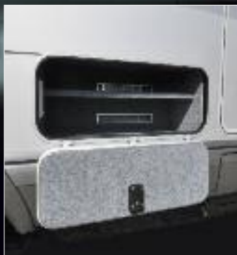
Ulteriori spazi di carico nel doppio pavimento al sicuro dal gelo riscaldati e con sportelli coibentati
