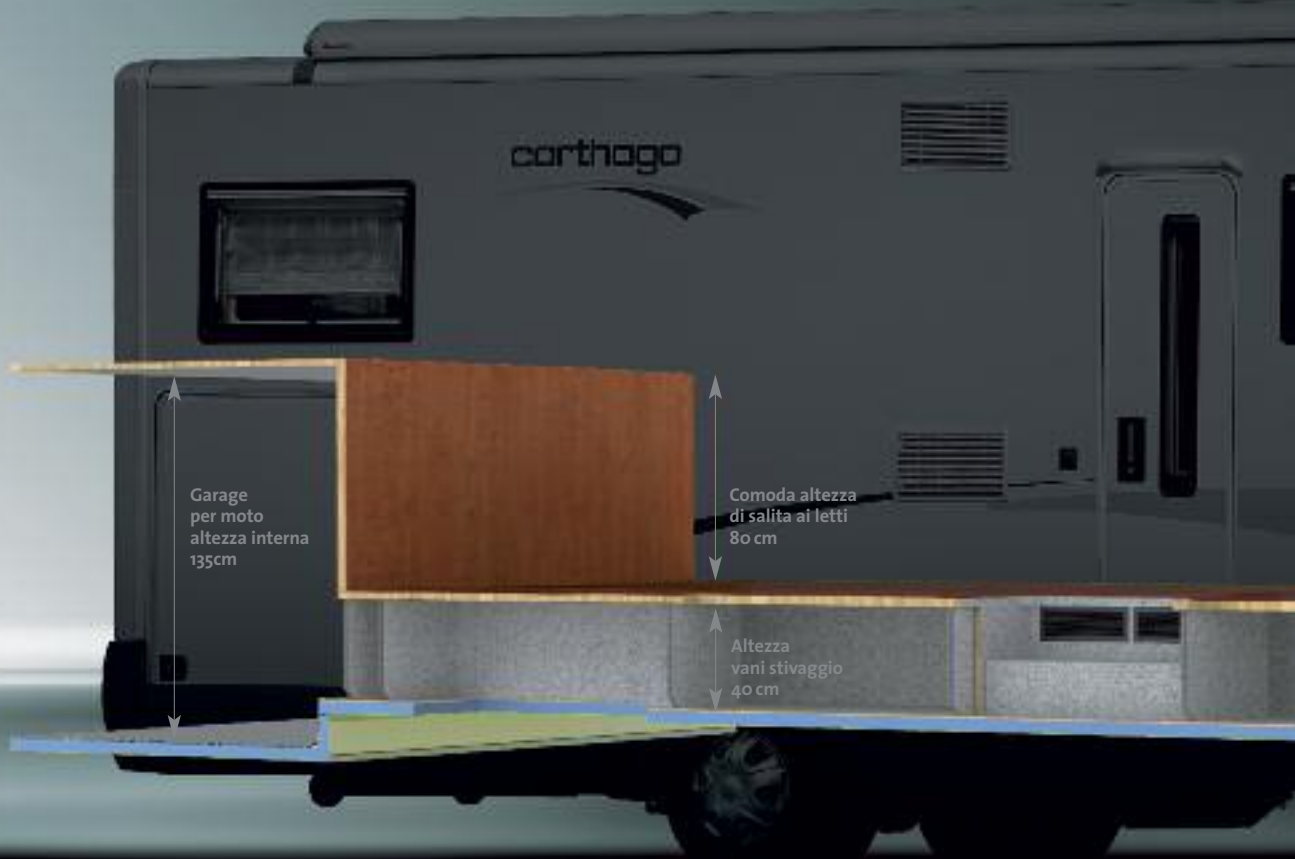
garage profondamente ribassato, completamente isolato, con 2 grandi sportelli di accesso e binari con anelli di ancoraggio regolabili
