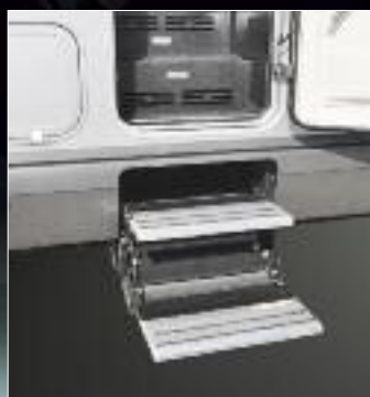
gradino di entrata elettrico incassato nelle bandelle laterali
