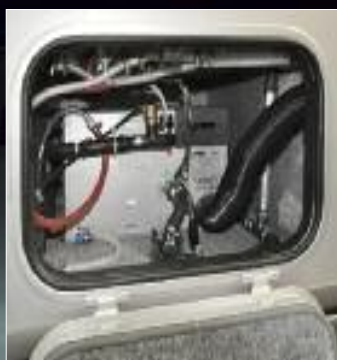
Attraverso gli sportelli nel doppio pavimento, comodo e veloce accesso agli impianti tecnici.
