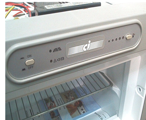
Pannello frigo con AES FOTO 25
