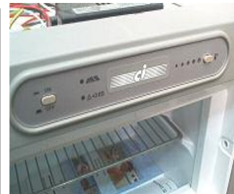
Pannello frigo con AES FOTO 17
