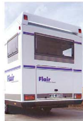
Der Heckspoiler mit integriertem Rücklicht gehört zur Serienausstattung des integrierten Flair .
