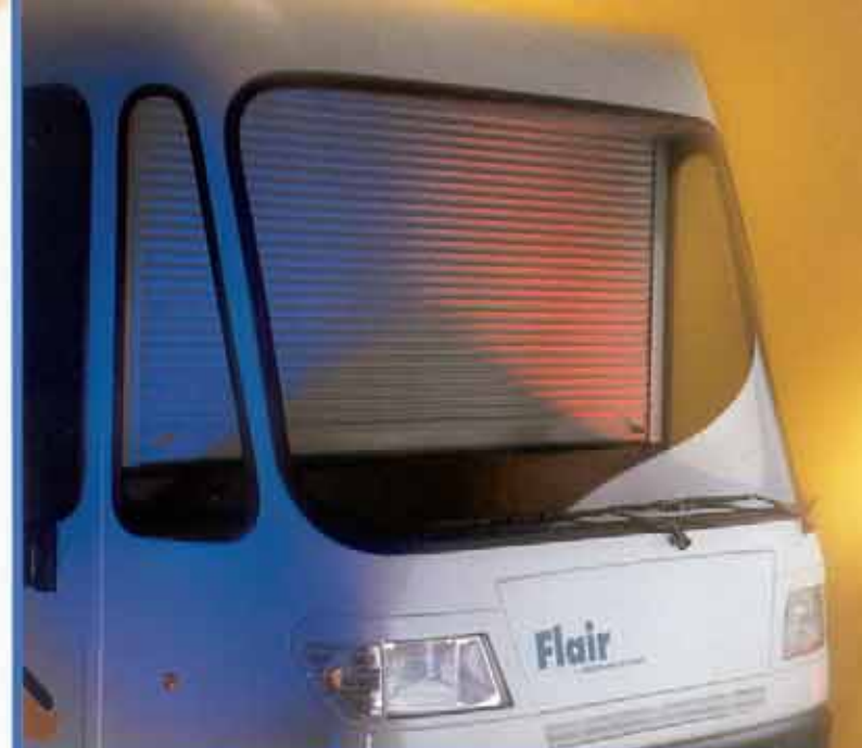
Das Isolationsrollo schützt vor Hitze und Kälte
