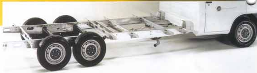
Der verzinkte Alu-Tiefrahmen ermöglicht die Doppelboden-Konstruktion und unbeschwertes Fahrvergnügen
