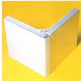
Die Flair-Ringanker-Wandverbindung: 35 mm starke Dach- und Seitenwände aus Aluminium (außen 1 mm – innen 0,8 mm), dazwischen Styrofoam
