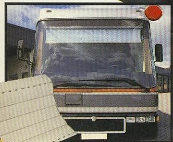
Ein Rollo an der Windschutzscheibe dient dem Fahrer als Sonnenschutz. Es kann während der Fahrt per Knopfdruck stufenlos der Sonneneinstrahlung entsprechend eingestellt werden. Durch die groß dimensionierte Windschutzscheibe erleben Sie die Umwelt wie aus der Sicht einer Weitwinkelkamera. Und Sie genießen es.
