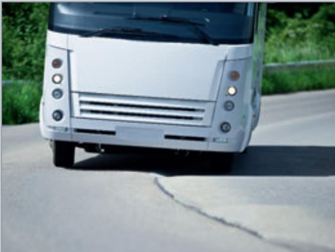
■ Un altro tratto della pista imita le strade acciottolate del Belgio. Il cosiddetto »blocco belga« fa parte di quasi tutte le aree di prova. La pista è pavimentata con pietre irregolari, accidentate, con buche, per provare l'efficacia delle sospensioni e la longevità degli elementi dei componenti dell'autotelaio.
