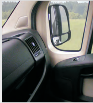
Radiovorbereitung mit Lautsprechern und integrierter Antenne im Außenspiegel
