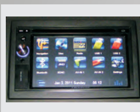
Moniceiver 6,2" TFT Touch Screen Display, Navigation, DVD-Player, Bluetooth, Freisprechanlage, USB-Anschluss, iPod/iPhone Direktsteuerung,...
