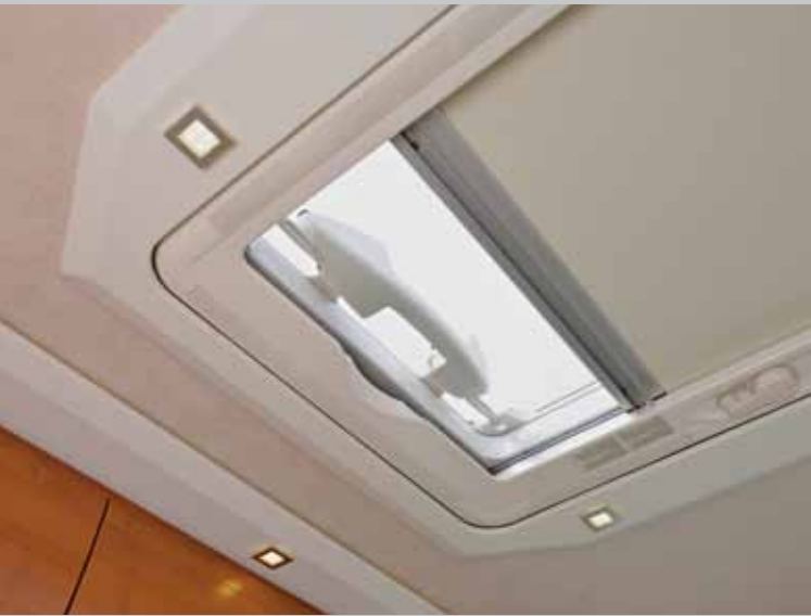
HeKi mit Deckenbaldachin und Beleuchtung
