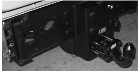
Die Chassisumbauten werden von MAN mit original MAN Teilen durchgeführt. Die MAN Abteilung Qualitätssicherung Aufbauhersteller (Abt. VSSK) hat in einem Produktaudit der Firma Schell Fahrzeugbau als **einzigem Hersteller von Reisemobilen** bestätigt, dass die erforderlichen Arbeiten an den Fahrzeugen nach den derzeit gültigen **MAN Aufbaurichtlinien und MAN Normen** durchgeführt werden. Dazu gehören unter anderem:
