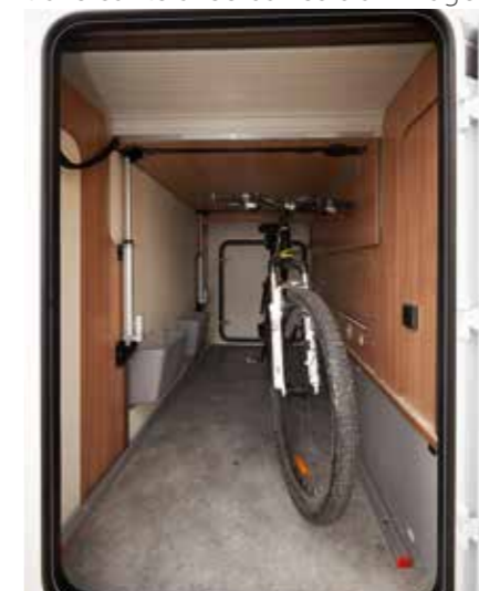
Soute isolée, chauffée et traversante avec barres d'arrimage
