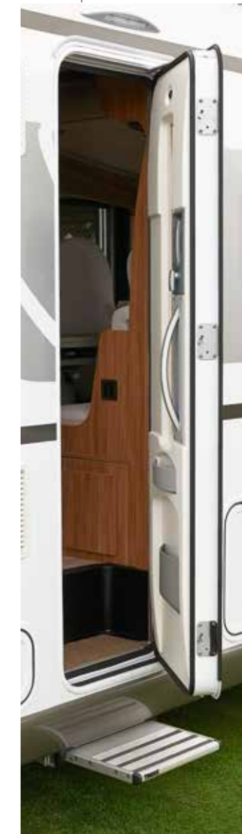
Porte cellule haute sécurité avec 3 points de serrure
