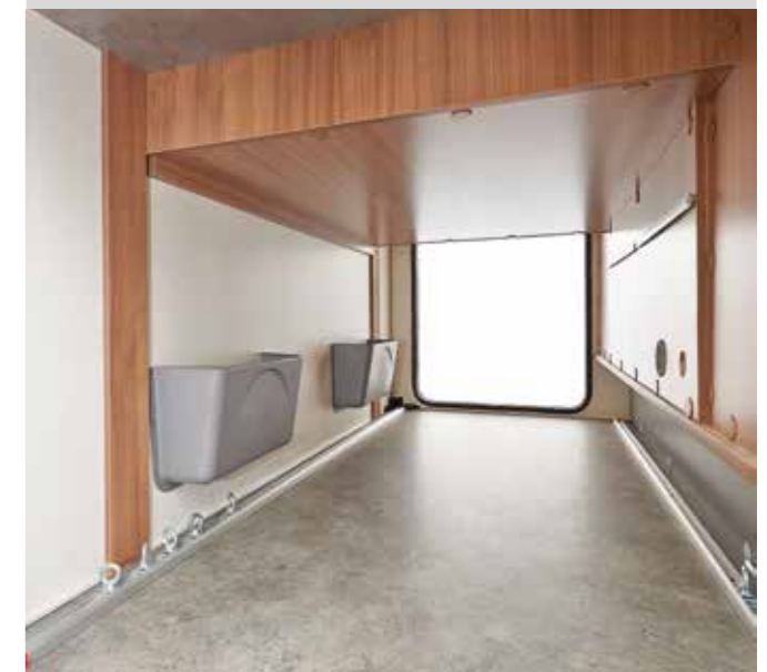
Soute traversante avec barres d'arrimage et rangement
