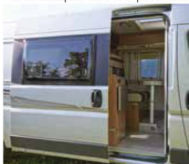
Porte bloquante à mi-parcours
