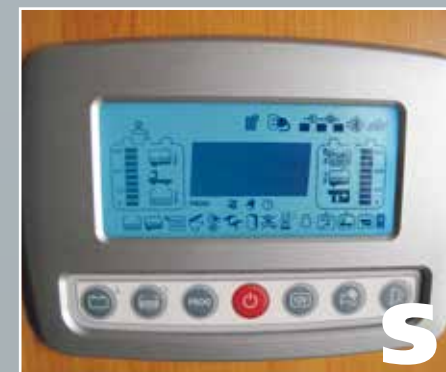
Bord-Control-System für Frisch- / Abwassertank, Aufbau- / Fahrzeugbatterie, 12-V-Hauptschalter und Wasserpumpenschalter. (nicht bei TRAIL / BOX 200)
