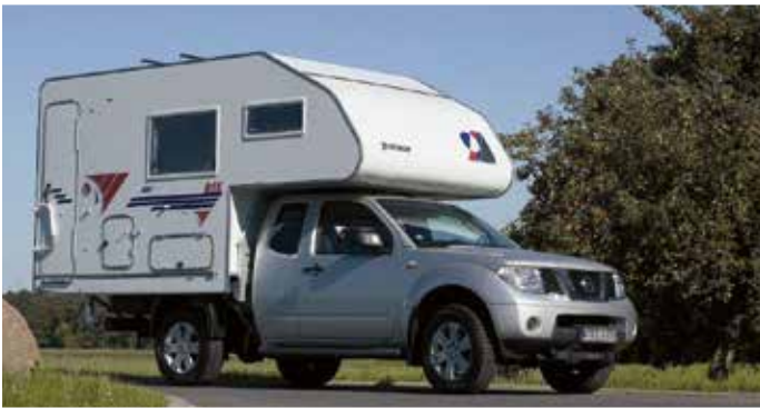
TRAIL 260 S Plattform auf Nissan Navara K/C, Plattform-Pritsche mit klappbaren demontierbaren Bordwänden
