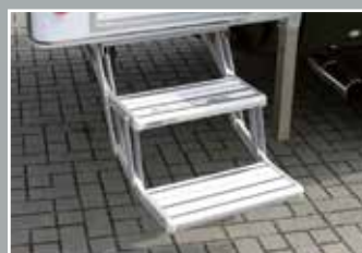
Elektrische Einstiegsstufe, 2-stufig, 12 V
