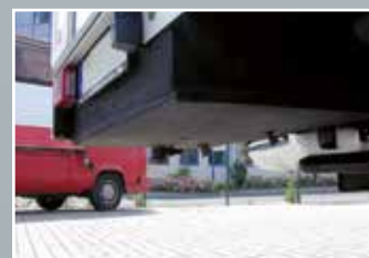
Abwassertank, isoliert und beheizt
