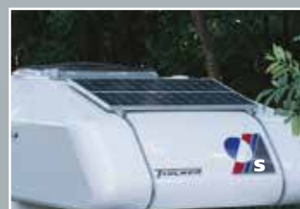
Solaranlage, bestehend aus einem 100-Watt-Modul, Ladestromregler
