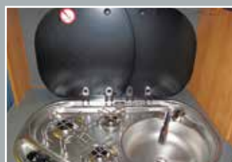
Kocher-Spüle-Einheit, 3-flammig mit elektronischer Zündung und 2-teiliger Glasabdeckung
