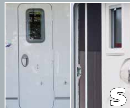
Eingangstüre mit Sicherheitsschloss und Moskitorollo, Fenster und Mülleimer
