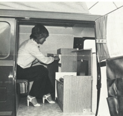
Kombischrank mit Mehrzweck-Küchenmöbel, 2-flammiger Gaskocher, Gasanlage und Regler, passend für 5 kg-Gasflasche, Wasserkarister 10 l
