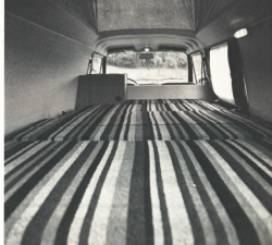
Blick nach vorn bei Schlafstellung. Bettengröße ca. 2000 x 1300 mm. Im Hintergrund links Kombischrank mit Gasflasche
