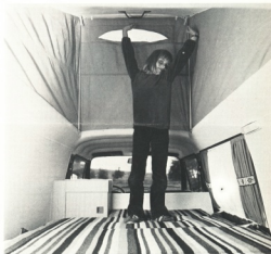
Reichliche Stehhöhe bei geöffnetem Ausstelldach mit Lüftung und Fliegenschutz in der oberen Dachhälfte. Rechts Türschiebefenster mit Gardinen und Fliegenstores
