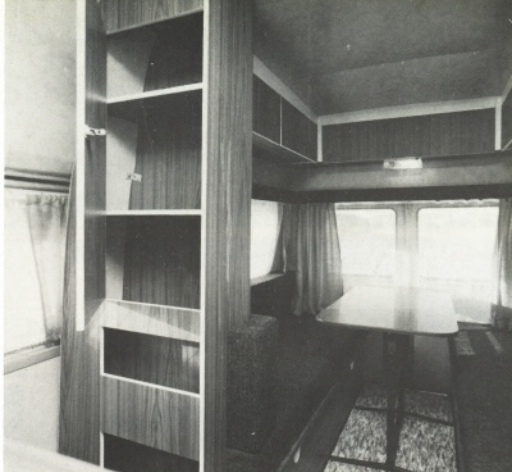
Wohnraum von vorne, geräumige Dachstaukästen mit großflächigen Klappen ringsum über Sitzgruppe, Kombileuchte 12/220 V, Schwenktisch, links ein raumhoher Geschirr- und Vorratsschrank.
