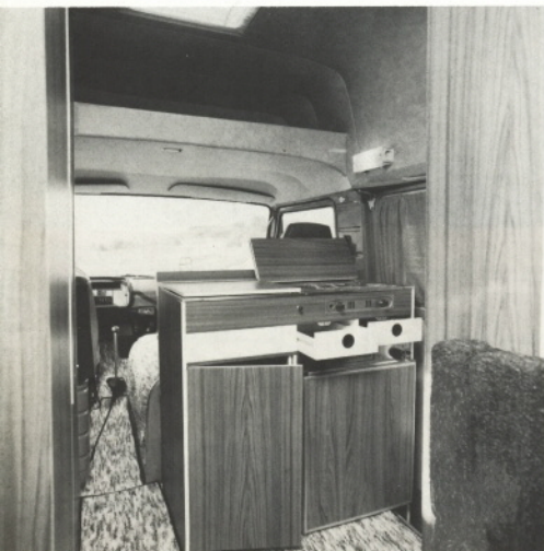
Küchenblock mit Abdeckung, Nirostaspüle, 2-flammigem Gasherd, 2 Schubladen, Kühlschrank 60 Ltr., elektr. Wasserversorgung mit zwei 20 Ltr. Wasserkanistern, Kombileuchte 12/220 V, großer Dachstaukasten über Fahrerhaus, ca. 0,6 cbm.
