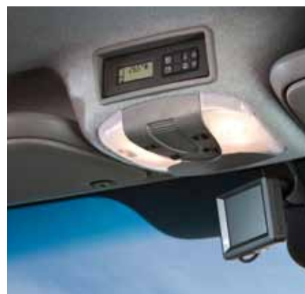
▲ Alles im Griff – das Bedienpanel für die Bordelektrik im Sven Hedin.
