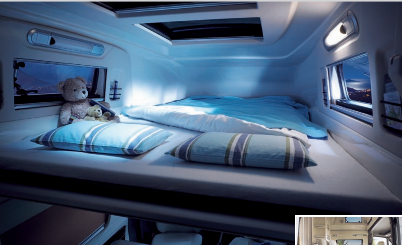
Für gesunden und erholsamen Schlaf sind alle Betten auf Federelementen gelagert. Diese ermöglichen zudem ein ausgeglichenes Schlafklima durch ausreichende Luftzirkulation unterhalb der Matratze.
