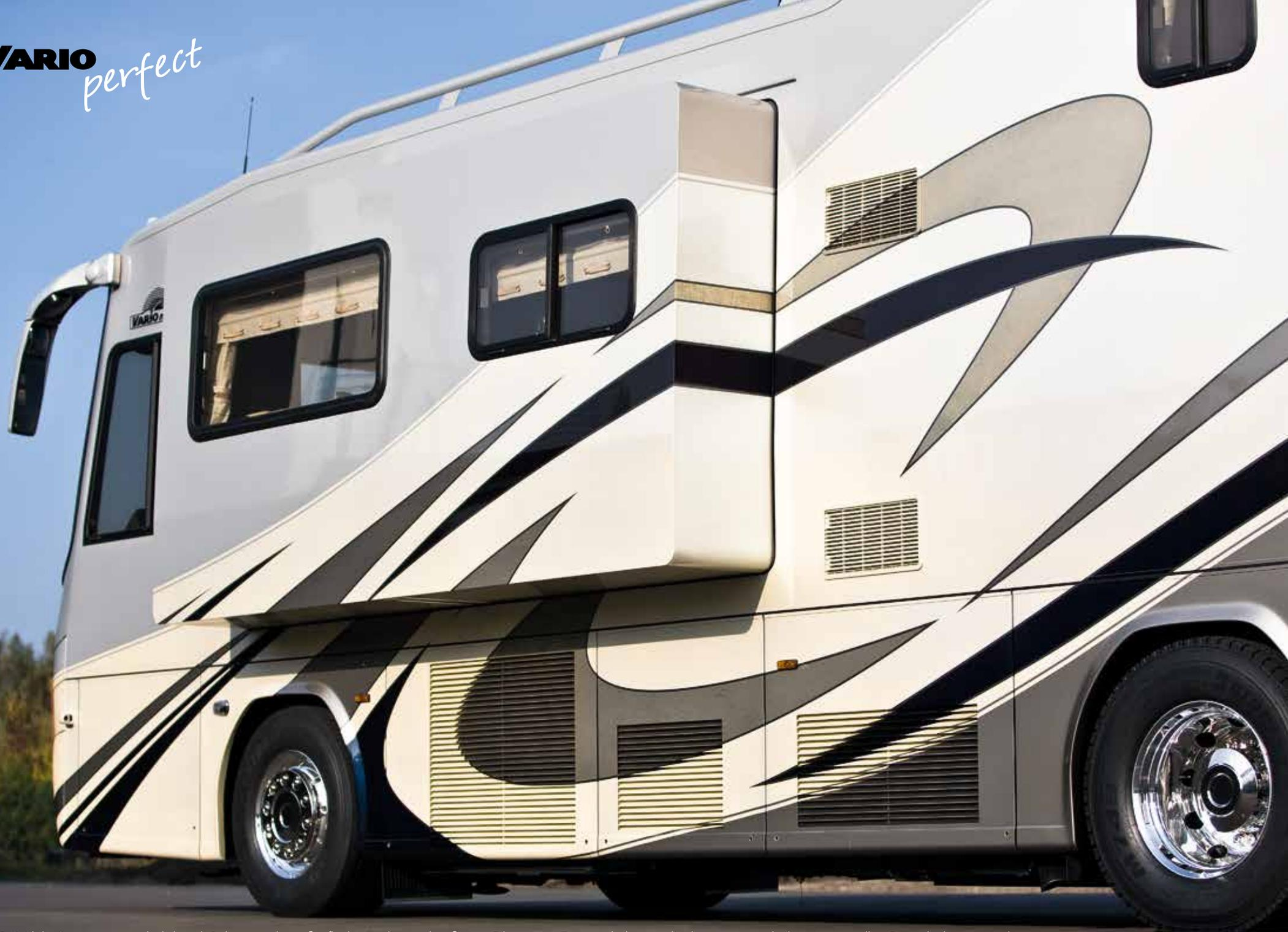
VARIO Slide Out - pneumatisch dichtend, Beheizung der Außenfläche, exakte Spaltmaße von Erkersystem, Türen und Klappen, hochwertiges Autolacksystem, Metallic - Designlackierung rundum
