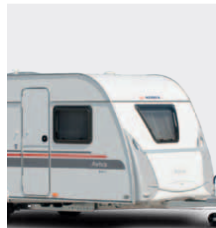
Costruzione in poliestere con pareti laterali in alluminio
