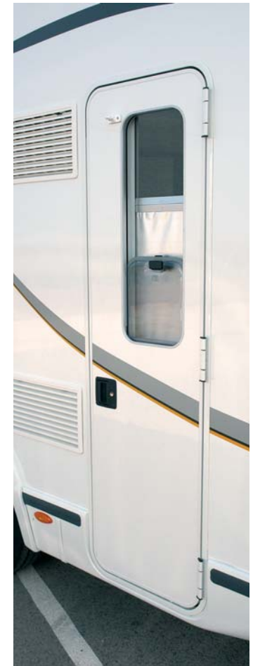
Porta con finestra, 2 punti di ancoraggio e chiusura centralizzata.
