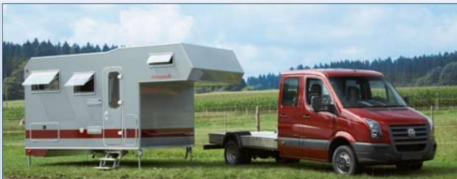
**La nostra cabina LB365 montata su VW Crafter è disponibile nelle versioni a cabina singola e doppia. In entrambi i casi, il veicolo può essere dotato di sistema di montaggio rapido che consente di rimuovere e montare la cabina con rapidità e facilità. Per rendere questo veicolo un vero veicolo a doppio uso, è possibile alternare la cabina con i pianali o i vani di carico.**
