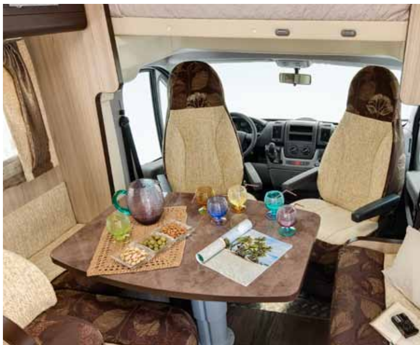
Tavolo dinette a isola con movimento orizzontale e trasversale con piano laminato Table dinette orientable
