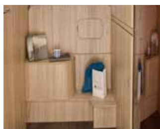
Gradini per accesso al letto posteriore con stivaggio Marches d'accès au lit arrière avec espace de rangement
