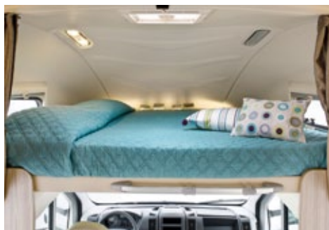
Mansarda monoscocca in vetroresina con due finestre e oblò / Capucine monoque en polyester avec deux baies et lanterneau
