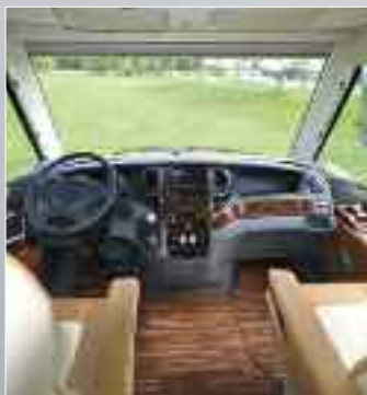
Komfort-Fahrerhaussitze SKA nach außen versetzt für breiteren Fahrerhausdurchgang und mehr Sitzkomfort in Wohnraumstellung.
