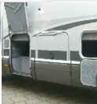
Zusätzliche Staufächer im Doppelboden integriert, frostsicher beheizt, rundum isoliert.
