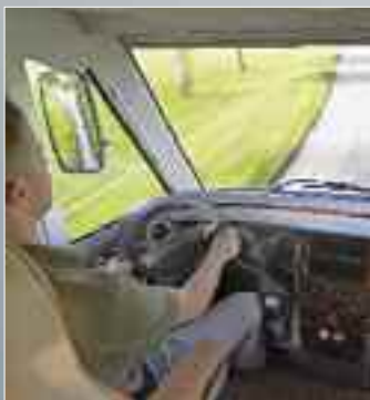
Nach oben versetztes Fahrerhaus: bessere Sicht durch erhöhte Sitzposition, „Linerfeeling“.
