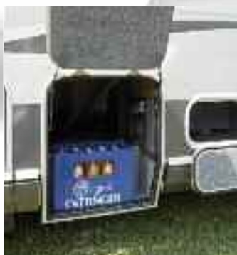
Doppelboden-Unterflurraum mit großer Außenklappe.
