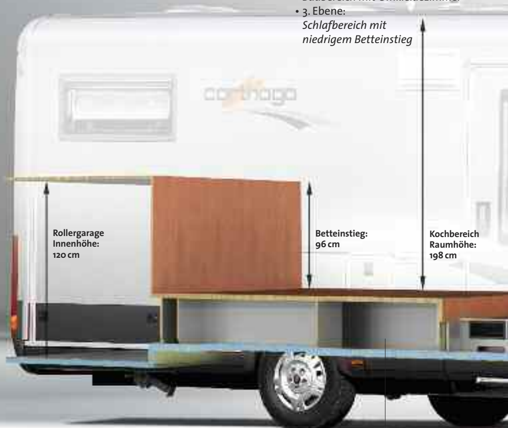
Doppelboden-Unterflurraum mit großer Außenklappe.
