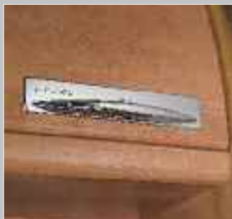
“Pull-open” massive Griffleiste mit Chrom-Zierblende an Dachstauschränken.
