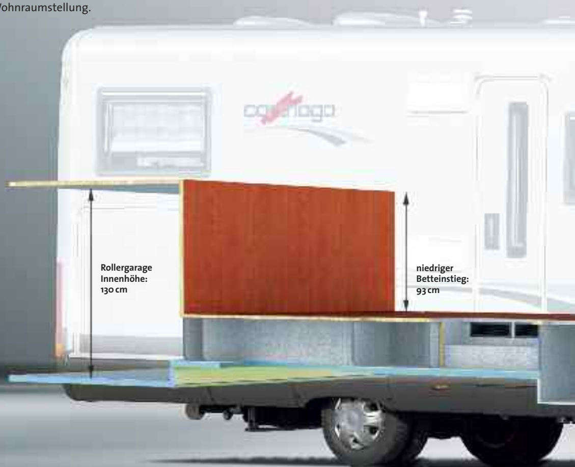
Zusätzliche Staufächer im Doppelboden integriert, frostsicher beheizt, rundum isoliert.
