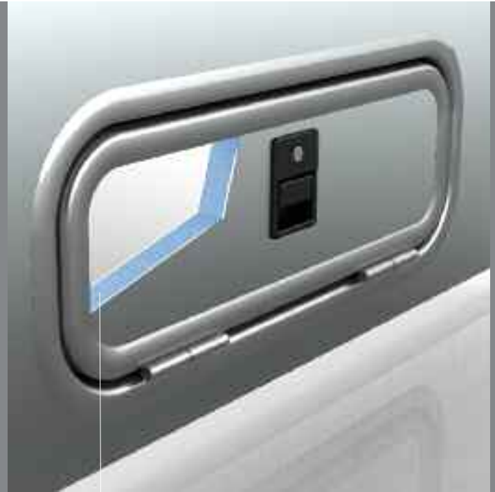
Außenklappen mit gleichem Sandwich-Aufbau wie Seitenwände
