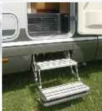
Elektrische Einstiegsstufe hinter Seitenschürze versenkt.
