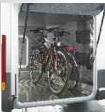
Rollergarage mit großer Innenhöhe durch Heckabsenkung.
