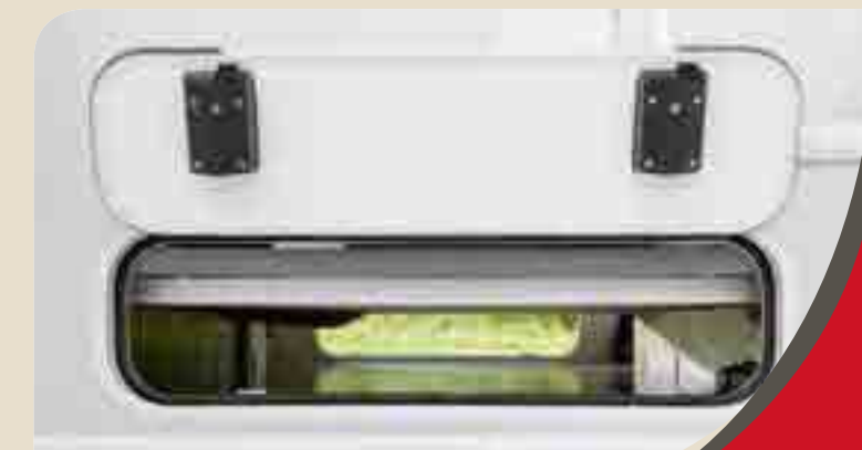
► Frostgeschützt: 20 cm hoher Funktions-Doppelboden
