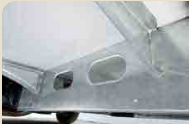
► Wasserresistent: Holzfreier Unterboden beidseitig mit GFK Platten verkleidet
