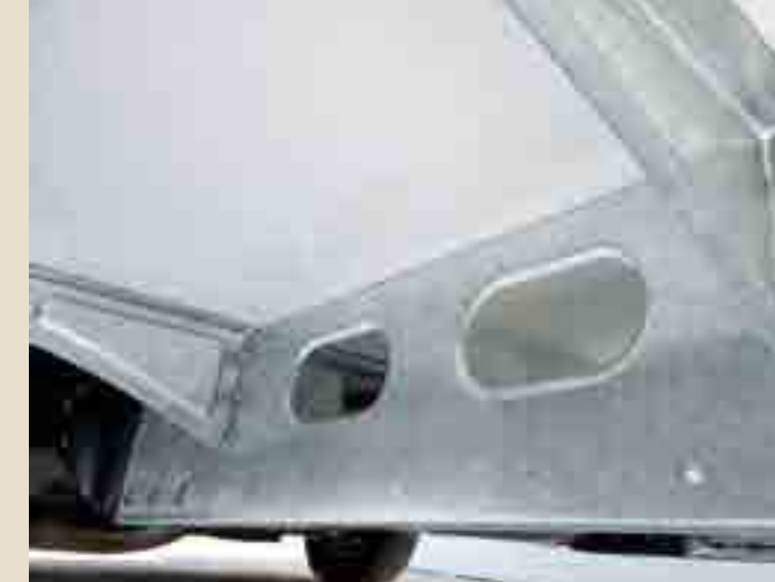
► Wasserresistent: Holzfreier Unterboden beidseitig mit GFK verkleidet
