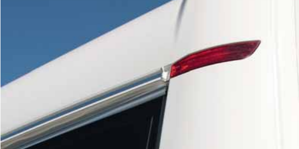
Kombinierte LED-Schluss- und Bremsleuchte , dadurch dreifache Sicherheit im Straßenverkehr.
