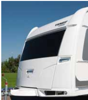
Bug und Heck im LFI-Verfahren (Verfahren zum Verarbeiten faserverstärkter Polyurethansysteme), besonders stabil und widerstandsfähig.
