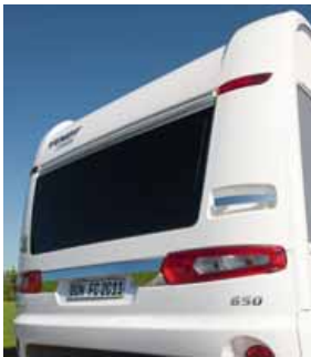
Bug und Heck im LFI-Verfahren (Verfahren zum Verarbeiten faserverstärkter Polyurethansysteme), besonders stabil und widerstandsfähig.
