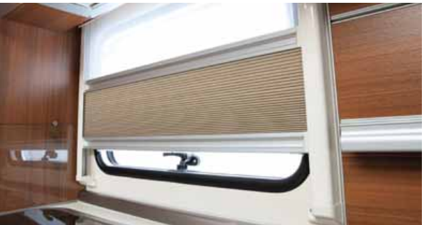
Fenster-Softrollos in Plisseeoptik mit materialschonenden und geräuscharmen Rückzugsdämpfern.
