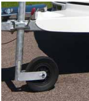
Stützrad mit härterer Gummierung und Lastanzeige zur einfachen Kontrolle der Stützlast.
