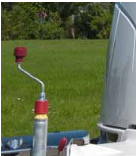
Stützrad mit härterer Gummierung und Lastanzeige zur einfachen Kontrolle der Stützlast.
