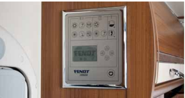
Zentrales Schaltpanel im Eingangsbereich für Licht, Wasserstandsanzeige, Zeit/Uhr, Temperatur und Fußbodenheizung.
