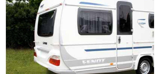
Gewölbtes Heck führt zu mehr Nutzlänge (Innenlänge).
