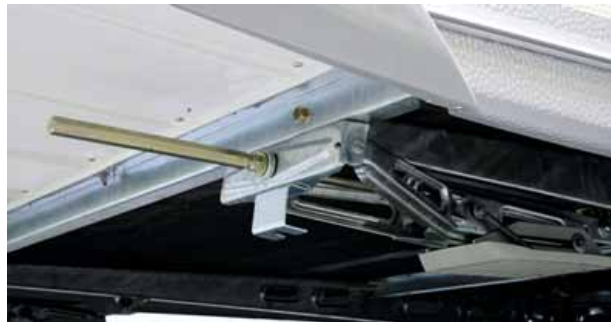
Kurbelstützen vorn und hinten mit Spindelverlängerung für deutlich leichteres Handling.
