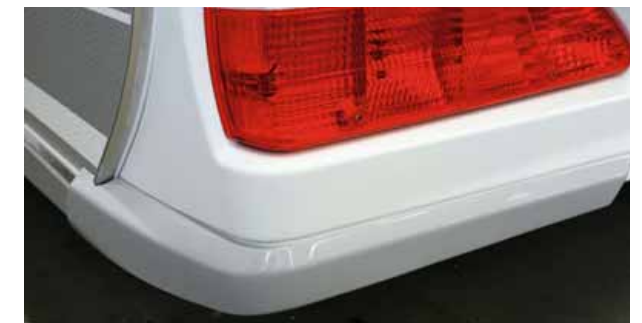
Eckelemente hinten links/rechts als Einzelkomponenten verbaut.
