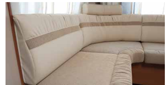
Großzügige Sitzgruppe mit komfortabler Sitztiefe im Heck quer. Optimale Polsterhinterlüftung/ Zirkulation und Warmluftführung im Heck sowie verstärkte Winterbelüftung der Rundsitzgruppe durch zusätzliche Wandbelüfter.
