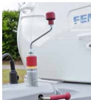
Stützrad mit härterer Gummierung und Lastanzeige zur einfachen Kontrolle der Stützlast.
