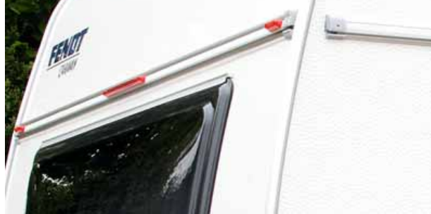
Integrierte Umrissleuchten in LED-Technik.
