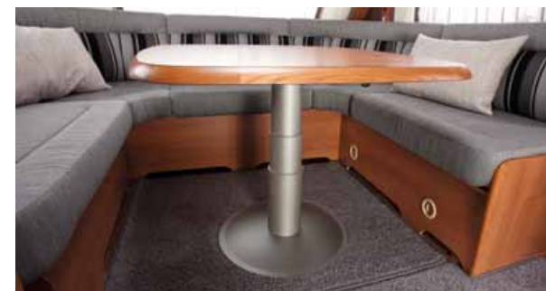
Einsäulenhubtisch kann stufenlos verstellt werden und bietet dadurch mehr Beinfreiheit in der Sitzgruppe.
