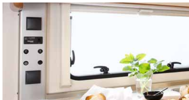
Schaltpanel Küche mit 2 Steckdosen, Schalter für Arbeitsplatzbeleuchtung 12/230V und Dunstabzug optional. Frischwasserfüllstandsanzeige mit Dioden [Bianco, Saphir, Platin, Topas].
