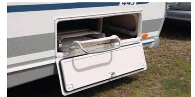
Serviceklappe mit größerem lichten Durchgangsmaß von jetzt 1050 x 280 mm [modellabhängig] .
