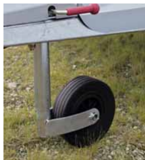
Stützrad mit härterer Gummierung und Lastanzeige zur einfachen Kontrolle der Stützlast.
