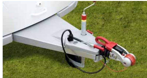
Optimierte Deichsel mit einem komplett selbsttragenden Gaskastenboden und einer dadurch vergrößerten freien Deichsellänge. Die dynamische Belastung von Deichsel-schwingungen wird nicht über den Gasflaschenkasten in den Aufbau eingeleitet.
