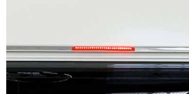
In Aluleiste integrierte Begrenzungs- und Bremsleuchte in LED-Technik.
