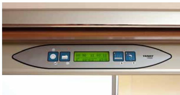
Küchencenter mit 2 Steckdosen, 12V-Arbeitsplatzbeleuchtung und Bordcontrol/Display (Uhrzeit, Datum, Innen-/Außentemperatur, Einstellung von Weckzeit). Eine Frischwassertank-Füllstandsanzeige zeigt an, wenn der Tank leer ist (akustisches Signal) [Diamant].
