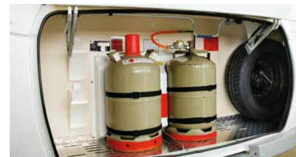
Gaskastinnenraum mit oberhalb der Gasflaschen platziertem Kurbelhalter. Reichlich Staufläche durch großen Rauminhalt, leichter Gasflaschenwechsel und leicht zugängliche Ersatzradhalterung (Ersatzrad optional).
