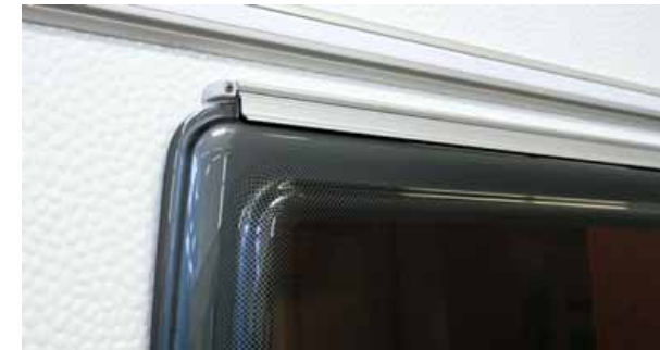
Fenster mit separaten Einhängeschienen und separater Markisenschiene oberhalb der Fenster , dadurch ist ein fensterunabhängiger Markiseneinzug möglich.
