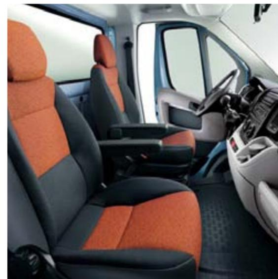
*Il sedile guida di Ducato può essere fornito con regolazione lombare e bracciolo. È inoltre disponibile un sedile ammortizzato, con regolazione del molleggio in funzione del peso del conducente.*
