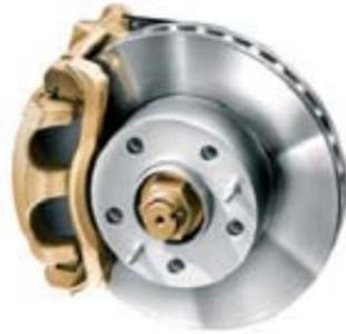
L'impianto frenante a doppio circuito incrociato dispone di freni a disco anteriori e posteriori. (I dischi anteriori sono autoventilanti, con diametro da 280 a 300 mm).
