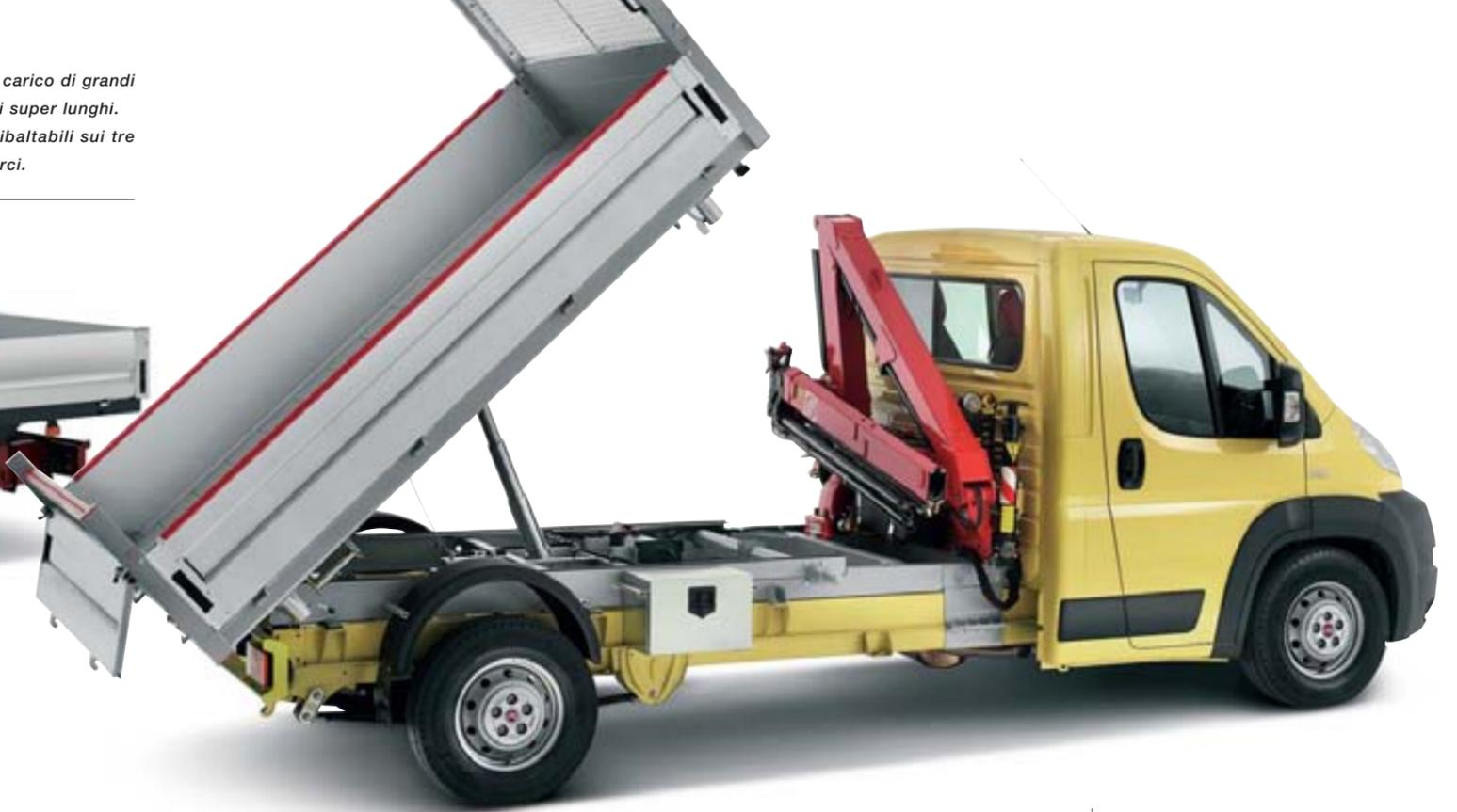
Nella versione maxi di Ducato, grazie al peso massimo di 2400 kg ammesso sull'asse posteriore, allestimenti come il cassone ribaltabile trilaterale con gru permettono il trasporto e la movimentazione di carichi pesanti con tutta tranquillità.
