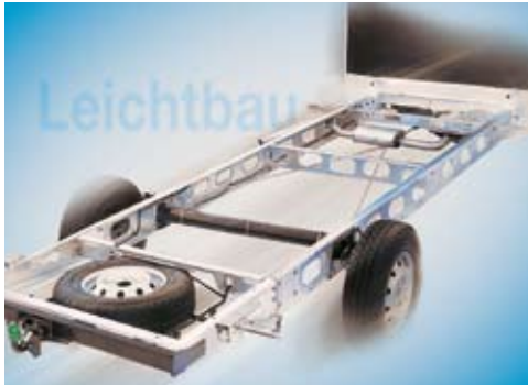
ALKO-Tiefrahmen-Chassis Fiat und Mercedes (6400/6800/7900 6T/ 8400 6T)
