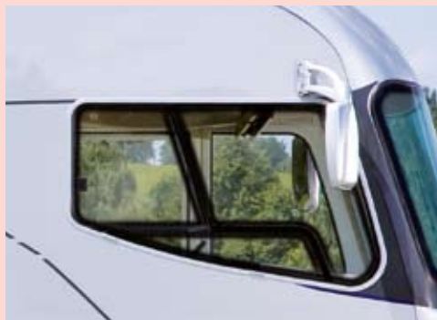
Isolierte Scheiben im Fahrerhaus, nur bei Integrierten möglich
