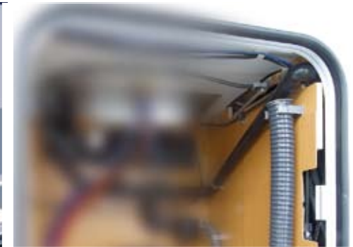
Füllschlauch für Frischwasser befindet sich, je nach Grundriss, bei der Heizungsklappe
