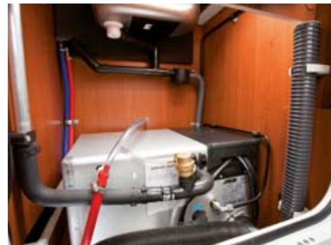
FRANKIA-Polarheizung (Option bei Compact/ Holiday/ComfortClass) für Warmwasserheizung mit Standheizung des Chassis
