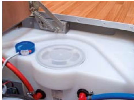
Frischwassertank im Doppelboden
