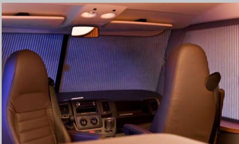
Un attraente sistema di oscuramento nella zona della cabina di guida protegge da sguardi indiscreti e crea oscurità. La soluzione integrata costituita da tenda avvolgibile frontale e da elementi laterali impedisce inoltre il surriscaldamento e il raffreddamento.
