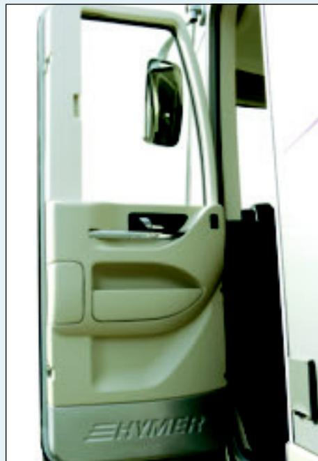
Porta del conducente. Design lineare con finestrino in continuità, alzacristalli elettrico, doppia chiusura, cerniere rinforzate, oscurante integrato, tenuta stagna e scomparti d'appoggio.
