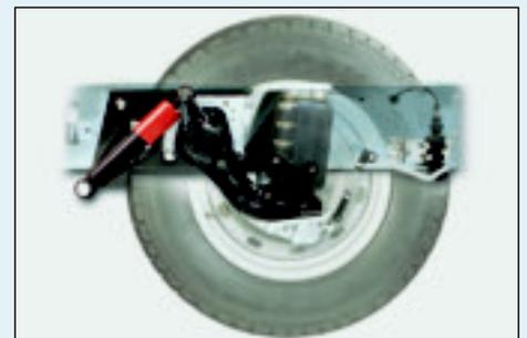
Sospensioni pneumatiche AL-KO. Sostituiscono le tradizionali sospensioni a molla. Trasmettono un gradevole confort di marcia, una migliorata tenuta di strada, aderenza in curva ed una ridotta deriva con vento laterale. Disponibili in opzione con il telaio AL-KO.
