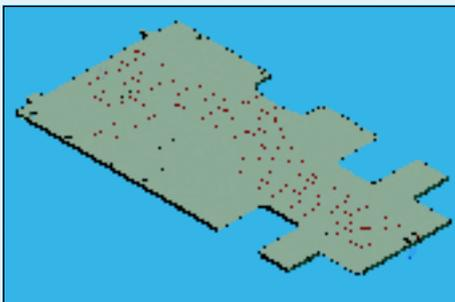
Riscaldamento a pavimento. Il riscaldamento a pavimento riscalda i vostri piedi persino nella zona doccia. Ideale presupposto per il campeggio invernale (L'illustrazione mostra il posizionamento delle spirali riscaldanti nel pavimento).
