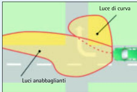
Luce di curva. L'installazione dei due fari proiettori con luce di curva vi consente curvando di illuminare quella parte che con i normali fari non è normalmente possibile fare. Per velocità inferiori ai 40 km/h la luce di curva illumina la zona della curva già con il lampeggio.
