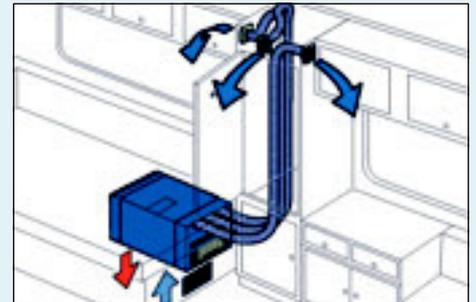
Innovativo sistema di climatizzazione. Basandosi sul climatizzatore Truma Saphir Comfort e grazie a scarichi lineari posti in alto, HYMER ha perfezionato con questo sistema di climatizzazione una distribuzione costante ed uniforme
