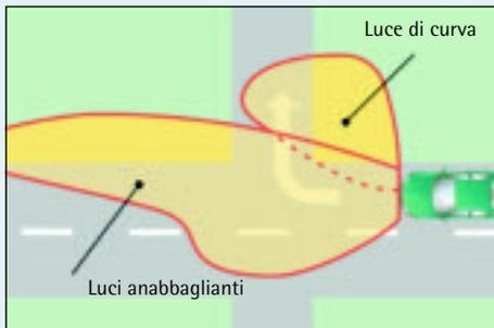
Luce di curva. Parallelamente con l'inizio della manovra di curvatura il cono di luce gira "intorno all'angolo". Per velocità inferiori ai 40 km/h la luce di curva illumina la zona della curva già con il lampeggio.
