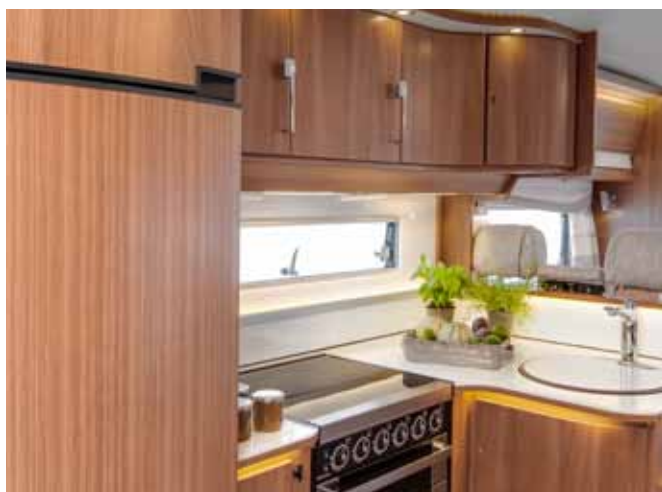
Der vollautomatische Kühlschrank mit AES schaltet je nach Situation automatisch zwischen 230-V-, 12-V- und Gasbetrieb um.
