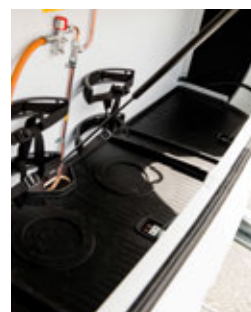
Formgegossene Schutzmatte im Gaskasten
