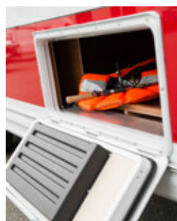
Stauraumklappe mit Luftkanälen unter dem Bett bei allen Modellen.
