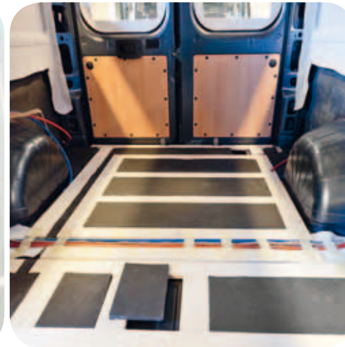
L'isolamento con espanso poliuretano da 20 mm assicura d'inverno una gradevole e completa protezione dal freddo.
