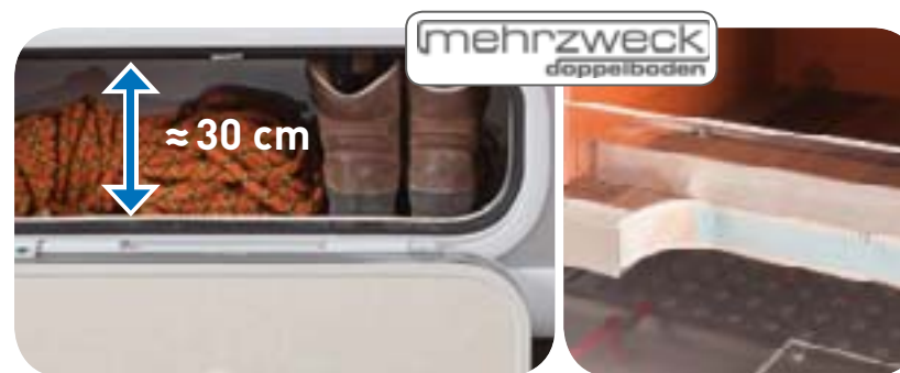
Accesso esterno al doppio pavimento con 30 cm di altezza interna.
