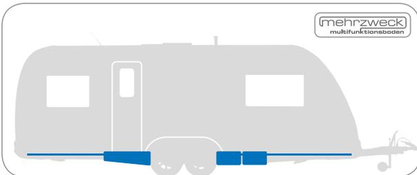
Erster Mehrzweck-Multifunktionsboden im Caravan: Optimale Fahrstabilität dank tiefem Schwerpunkt durch neu platzierte Versorgungseinheiten.
