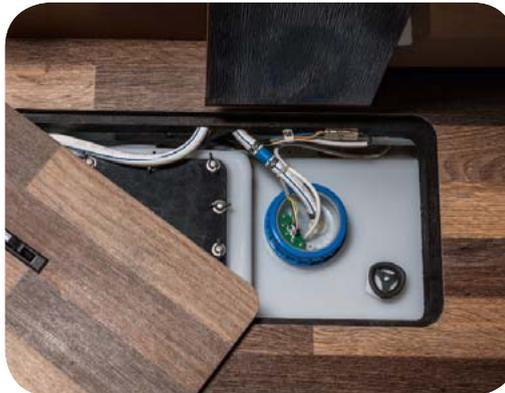
Beheizter Frischwassertank mit 35-mm-Isolierung.
