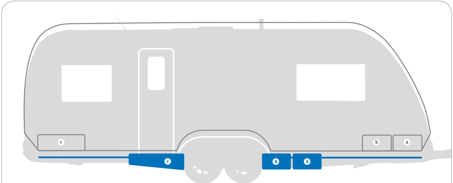
**Standard-Wohnwagen-Konstruktionen:** Die Versorgungseinheiten wie Batterie (a), Elektrik (b) und Frischwassertank (c) sind bei herkömmlichen Wohnwagenkonstruktionen im Bug und im Heck unterhalb von Betten und Sitzgruppen platziert.
