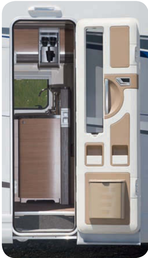
Porta di ingresso con cestello portarifiuti.
