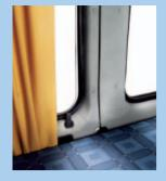
Die Isolierverglasung und die zusätzliche Isolierverkleidung der Heckflügeltüren macht den BOX STAR zum wintertauglichen Campingbus (im BOX STAR Paket).
