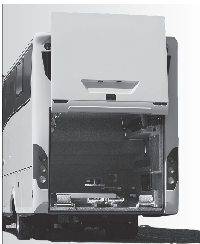
Sportello posteriore garage auto con apertura a parallelogramma
