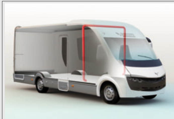
Per una maggior sicurezza degli occupanti la struttura anteriore ingloba un resistente Rollbar. (K-Yacht)
