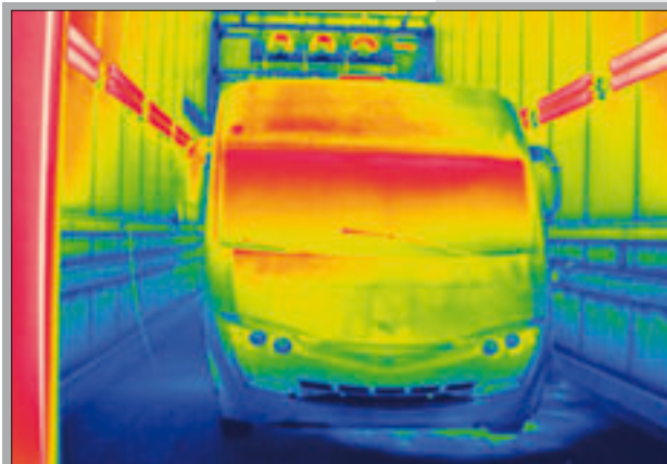
Prova riscaldamento secondo la norma EN 1646-1 con Truma Combi 6 superata.
