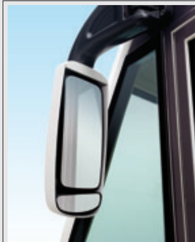
Specchi retrovisori elettrici multifunzione riscaldati con antenna incorporata e regolabili elettricamente dall'interno (K-Yacht).
