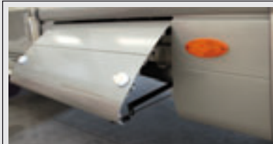
Predisposizione per l'alloggiamento del generatore, disponibile su tutti i modelli.
