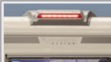
Terza luce di stop integrata nel termoformato posteriore.
